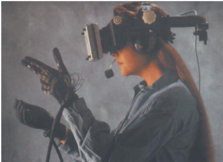
**Head Mounted Display (HMD) für die Bildausgabe, Mikrofon für die Spracheingabe und Datenhandschuhe für die Navigation im virtuellen Raum (NASA-Projekt)**
